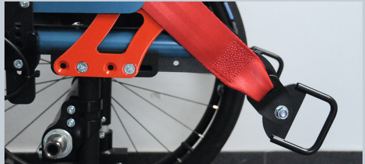
Zwei hintere Kraftknotensysteme mit jeweils einer Leichtbauöse für Spannretractor. Der Beckengurt ist bereits fest montiert.
