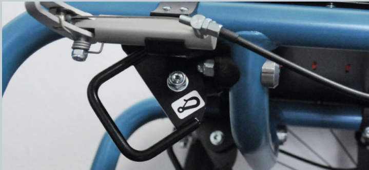
Zwei vordere Kraftknotensysteme mit jeweils einer Leichtbauöse für Spannretractor oder Statikgurt.
