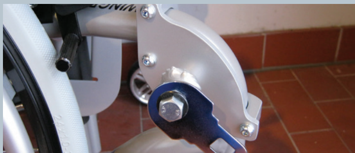
Zwei vordere Kraftknotensysteme mit jeweils einer Schwerlastöse für Spannretractor oder Statigurt.
