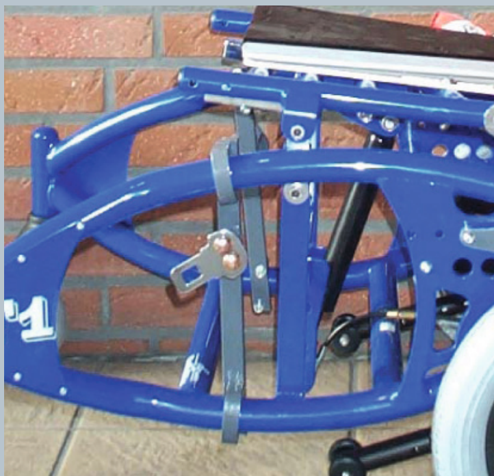
Zwei vordere Kraftknotensysteme mit jeweils einer Schwerlastöse für Spannretractor oder Statigurt.
